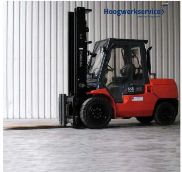
Uitgevoerd met side-shift en verstelbare vorken
