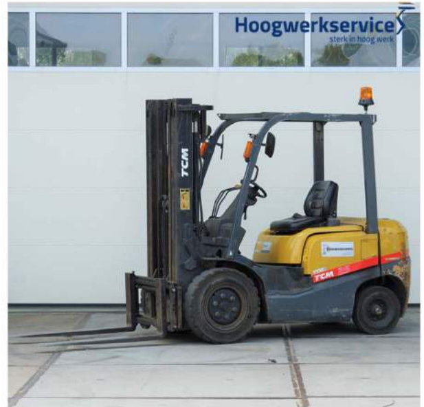
Uitgevoerd met side-shift en verstelbare vorken
