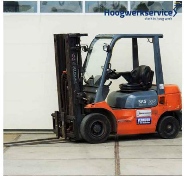
Uitgevoerd met side-shift en verstelbare vorken
