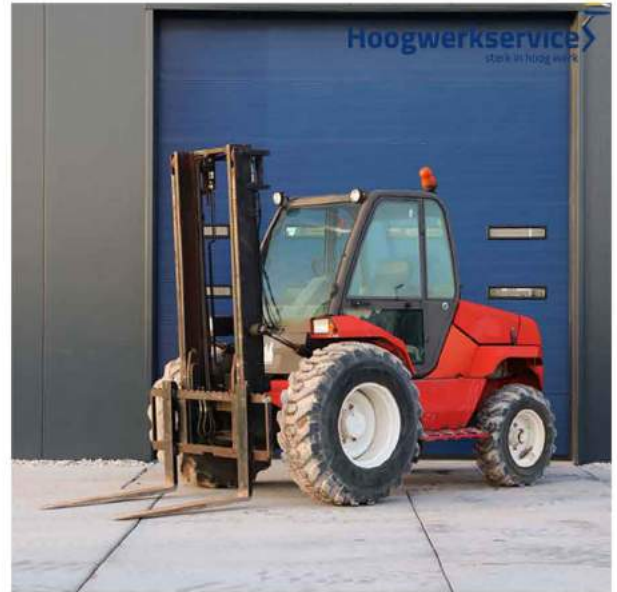
Uitgevoerd met side-shift en verstelbare vorken
