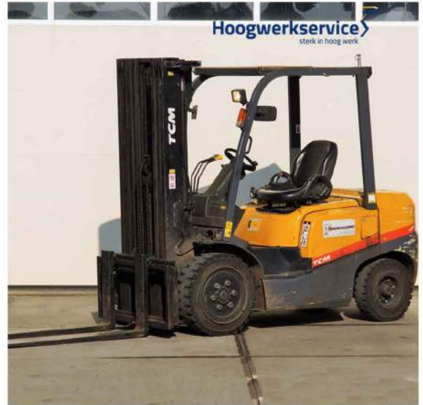
Uitgevoerd met side-shift en verstelbare vorken
